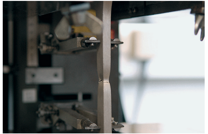
Abb. 2.3_2: Zugversuch als eine Möglichkeit für zerstörende Prüfungen
