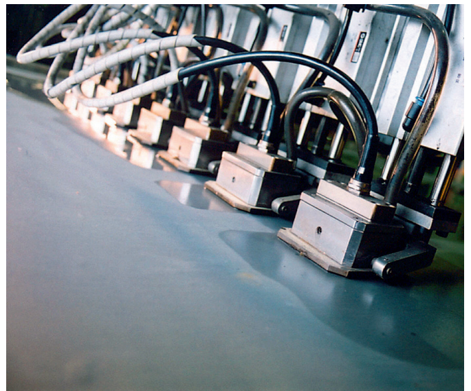
Abb. 2.3_3: Ultraschall-Prüfung bereits im Wareneingang
